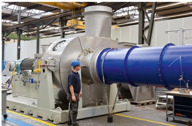
在管道测试台进行性能测试
